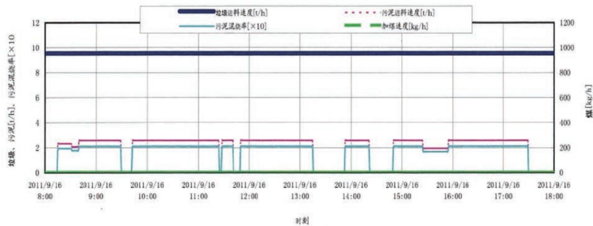
图4: 垃圾进料量、污泥进料量及加煤量变化图
