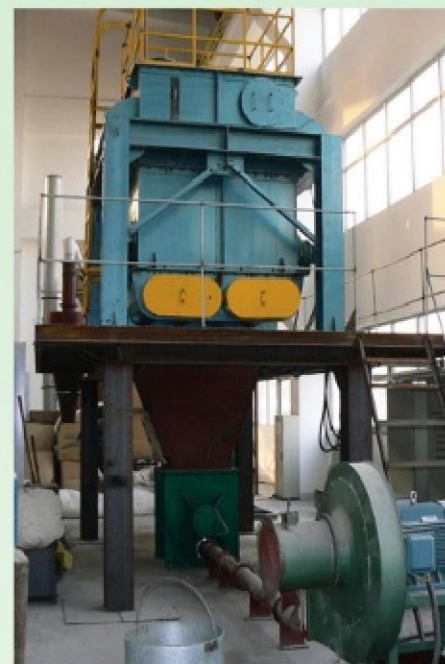
可燃物气力输送实验平台
